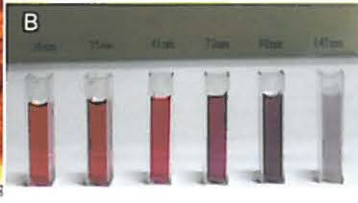
Şekil 1. Gümüş nanoparçacıkların atomik güç mikroskobu görüntüsü (A) ve altın nanoparçacıkların büyüklüğünün değişimi ile soğurma dalga boyunun büyümesinin renk değişimi olarak gözlenmesi (B).
