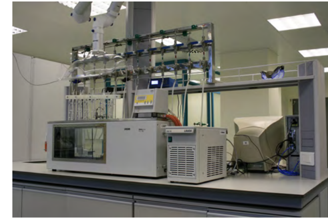
Şekil 4. TÜBİTAK UME Primer Seviye pH ölçüm sistemi
