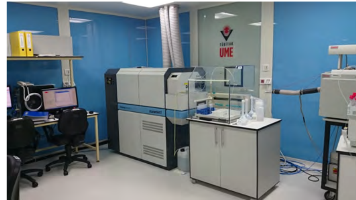
Şekil 7. İnorganik Kimya Laboratuvarı Temiz Oda HR-ICP-MS
